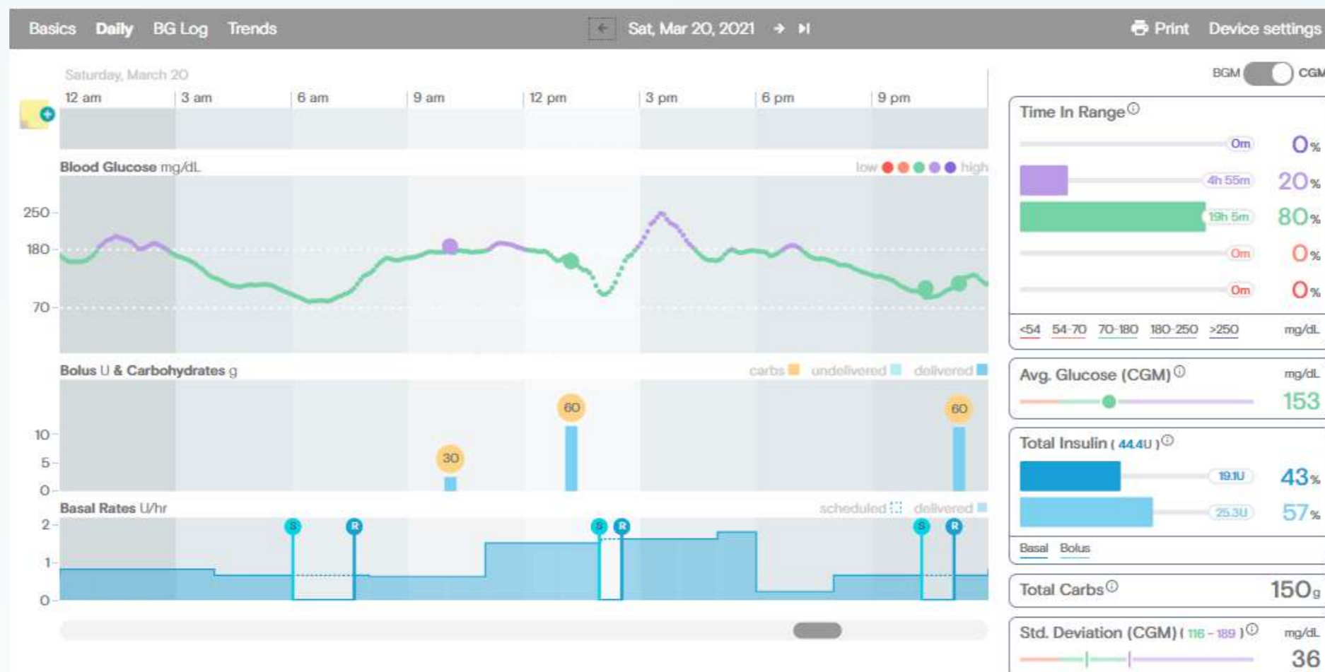
Figura 7. Interfaz correspondiente a la descarga de datos de infusor Medtronic 670G + MCG Enlite 3 en Tidepool
