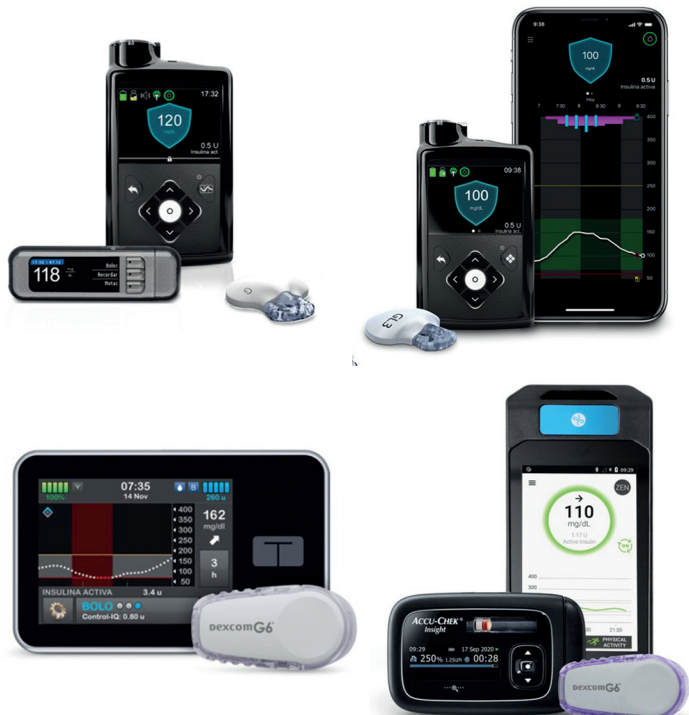
Figura 15. Sistemas de asa cerrada comerciales. De izquierda a derecha: Sistema MiniMed 670G™, sistema MiniMed780G, sistema Tandem t:slim X2™ con Control-IQ™, Sistema DBLG6®.
